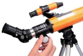
物体を観察する時、画像が鮮明になるまでフォーカスホイールを回します。ターゲットより近い物を観察する時は、フォーカスホイールを目の方向に回します。遠くのターゲットを観察する時は、反対方向にフォーカスホイールを回します。ご注意:観察する時に、シャープで鮮明な画像を得るために、窓を開けてください。
