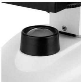
3、試料スライスを作業台に置き、可動定規でクランプして位置を調整し、観察対象物が光通過穴の中心にくるようにします。
