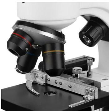
4、対物レンズを最も低い位置まで下げてから、粗調整でゆっくりと上に動かして比較的鮮明な画像を取得し、微調整を使用してより鮮明な画質を取得します。
